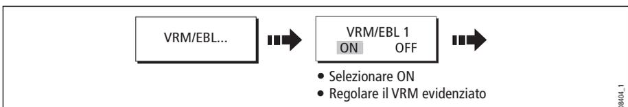
**Nota:** Il primo VRM/EBL verrà posizionato a 1/3 della scala corrente e a 030° in relazione alla prua dell'imbarcazione. Se questi parametri vengono modificati sono mantenuti in memoria e verranno utilizzati alla successiva attivazione del VRM/EBL.
