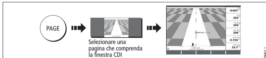
Quando l'applicazione CDI è visualizzata i tasti soft non vengono usati. Per accedere a qualunque funzione attivata tramite i tasti soft dovreste quindi aprire una finestra radar, chartplotter o fishfinder.
